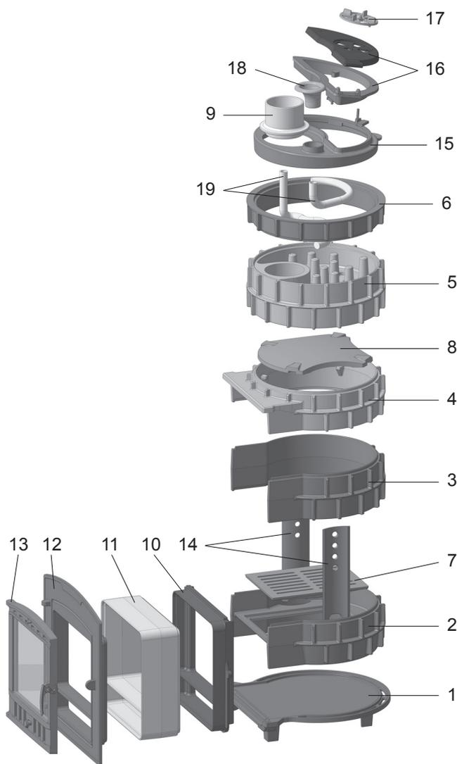
1 – основание с ножками; 2 – модуль топки; 3 – нижняя секция модуля корпуса; 4 – верхняя секция модуля корпуса; 5 – модуль каменки; 6 – наборное кольцо; 7 – колосниковая решетка; 8 – рассекатель пламени; 9 – стартовая труба дымохода; 10 – переходник; 11 – удлинитель портала; 12 – портал; 13 – дверка; 14 – воздушники; 15 – люк каменки; 16 – дверца для подачи воды; 17 – заслонка выхода пара; 18 – воронки для подачи воды; 19 – трубки для распределения воды.
