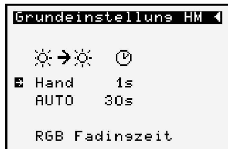
Рис. 31. Страница «RGB Fadingzeit» («Время затухания RGB-светодиодов — режим изменения», пример)
