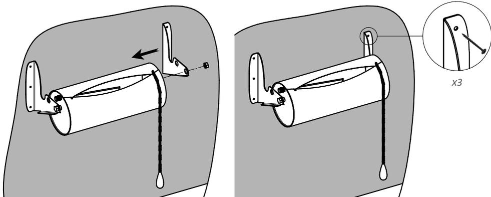
Примечание: выше описан порядок сборки и установки обливного устройства на стену. Процесс установки на потолок аналогичен, за исключением того, что ось корпуса **A** устанавливается в отверстия у основания кронштейнов **F**.
