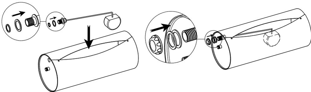
2) Установите цепь с ручкой **D** и закрепите ее с помощью гайки-барашка **E**.
