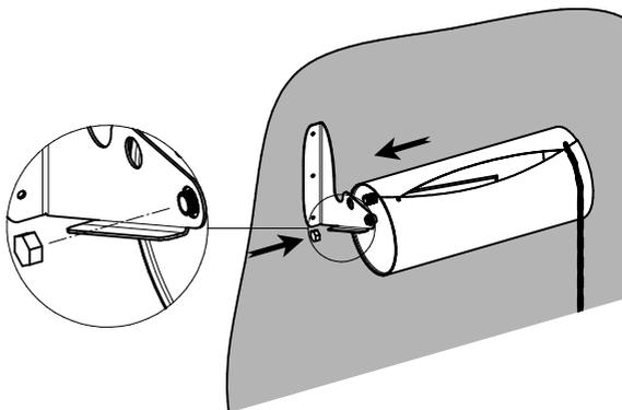
**ВНИМАНИЕ!** При установке устройства на стену ось корпуса вставляется в ближайшее отверстие (см. рисунок), при установке на потолок – в отверстие у основания кронштейна.
