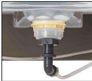
Angeschlossenen Behälter auf den Kopf stellen und in die Konsole schieben. Es ist darauf zu achten, dass der gelbe Flanschring in der dafür vorgesehenen Führung sitzt.
