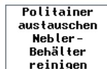
Den Solepolitainer mit der restlichen Desinfektionslösung entleeren, ausspülen und für die nächste Desinfektion aufbewahren. Den *Neblerbehälter (19)* ausbauen, entleeren, mit Trinkwasser ausspülen, und den leeren Behälter wieder einsetzen. Die Meldung am Display mit Enter bestätigen.
