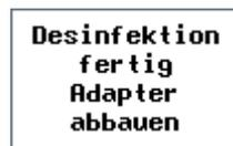
Das *Anschlusset (51)* am Nebelaustritt in der entsprechenden Kabine entfernen. Die Meldung am Display mit Enter bestätigen.
