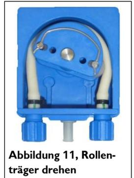
Nun die Sicherungsscheibe und die transparente Pumpenabdeckung wieder aufstecken. Damit ist die Rollenträgermontage abgeschlossen.
