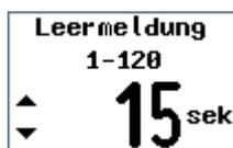
Läuft die Schlauchpumpe zur Befüllung des Neblerbehälters länger als die hier eingestellte Zeit, so wird die Störmeldung „Behälter leer“ angezeigt. Die gewünschte Zeit einstellen und mit der Entertaste speichern.
