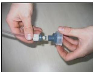
Politaineranschluss für SOLDOS vom Nippel der Saugleitung abziehen.
