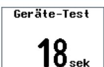
Beim Geräte-Test wird, für die angezeigte Zeit, die Vernebelung gestartet und alle Störmeldungen abgefragt. Den Geräte-Test mit der Entertaste starten. Abbruch mit Entertaste.
