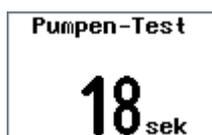
Die Schlauchpumpe wird für die angezeigte Zeit angesteuert. Den Test mit der Entertaste starten. Abbruch mit Entertaste.
