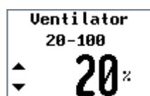
Hier die gewünschte Ventilatorstärke zum Einblasen des Solenebels in die Kabine einstellen und mit der Entertaste bestätigen.
