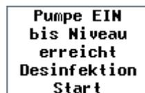
Die Schlauchpumpe fördert nun die Desinfektionslösung in den Neblerbehälter, bis der notwendige Füllstand erreicht ist. (Diese Meldung erscheint nicht, wenn sich im Neblerbehälter bereits Flüssigkeit befindet.) Nun startet die Desinfektion von selbst. Die Desinfektionslösung wird vom Ultraschallvernebler vernebelt und durch den Ventilator in das Neblerrohr und das Anschlusset geblasen.
