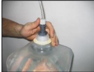
Saugleitung mit Nippel in den Politaineranschluss einstecken.
