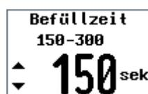
Wird das Gerät eingeschaltet, muss der Neblerbehälter zuerst mit der Schlauchpumpe befüllt werden. Die Befüllzeit hier einstellen und mit der Entertaste speichern. Die Befüllzeit endet mit dem ersten Ansprechen des Leerschalters. Spricht der Leerschalter während der Befüllzeit nicht an, so erscheint die Störmeldung „Befüllzeit überschritten“.
