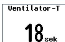
Der Ventilator wird für die eingestellte Zeit angesteuert. Den Test mit der Entertaste starten. Abbruch mit Entertaste.
