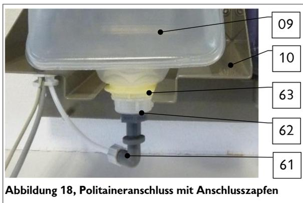
Abbildung 18, Politaineranschluss mit Anschlusszapfen
