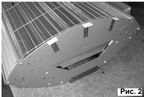
Аккуратно надвиньте боковую накладку на торец, так чтобы её края совпали с основным корпусом и прижмите её к крепежным уголкам (клейкие элементы должны приклеиться к накладке и зафиксировать её положение).
